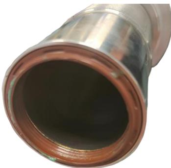
L'amortisseur coulisse dans la jambe de force grâce à des bagues de guidages, un joint racleur protège l'intérieur de la jambe des forces. Ces pièces doivent être graissées avant le montage.
