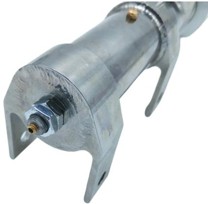
Une fois la tige épaulée contre le fond de la jambe de force, visser l'écrou et le contre écrou à en bloquant la rotation de la tige avec une clé de 10. Enfin, laisser dépasser la vis hexagonale de l'intérieur de la tige.
