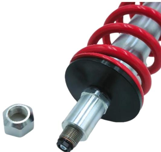
De l'autre côté de l'amortisseur se trouve la fixation haute qui vient se monter au travers des coupelles de la voiture. Serrer l'écrou de 27mm à l'aide d'une clé à choc.
