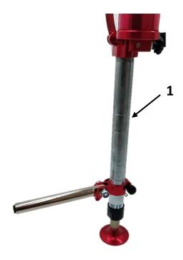
Positionner le circlip (n°2) dans la gorge correspondant à la hauteur voulue, par rapport à la hauteur du tube de levage de votre véhicule, en tenant compte du cas de la crevaison, où le véhicule peut être plus bas.
